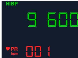
3. Drücken Sie die Taste
