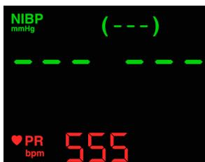
4. Drücken Sie die Taste
